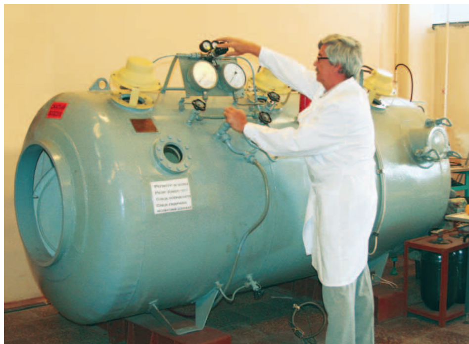
Испытания в глубинной камере, имитирующие погружение на глубину до 100 м
