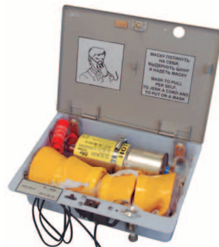
Аварийный кислородный блок АКБ-204
